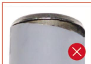
切断的时候用手抓住管子往前转切断,如果切断面不是直角插入整平套会偏心。
