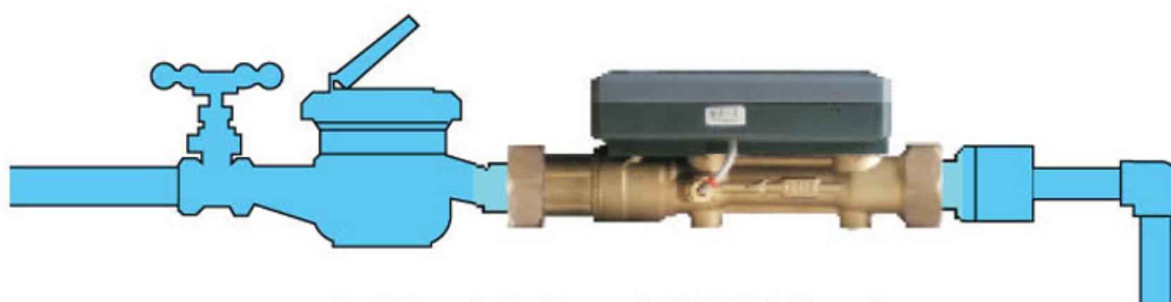
智能漏水保护器主管道安装示意图
